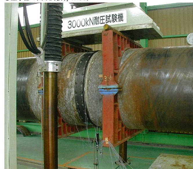
●継手部の曲げ試験(φ1200)
