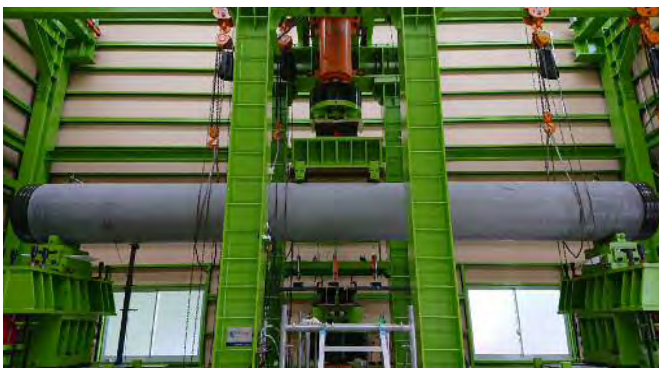
曲げ耐力試験状況
