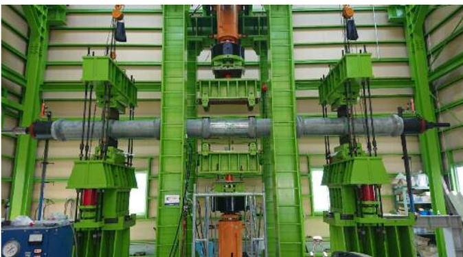
漸増変位軸力曲げ耐力試験状況
